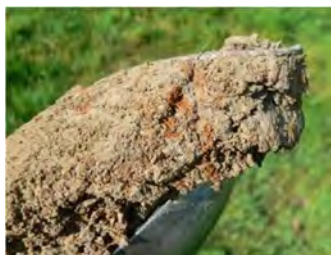
Figure 5 – Pseudogley caractérisant une oxydation de l'élément fer
