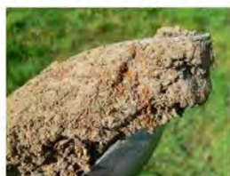
Figure 5 – Pseudogley caractérisant une oxydation de l'élément fer
