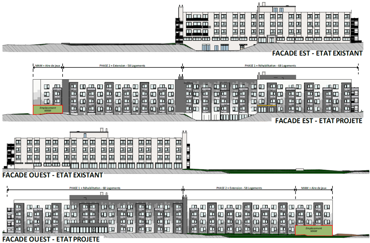
Plan des façades Est et Ouest état existant et projeté – source CBA
